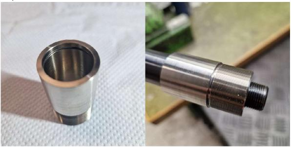
Im nächsten Schritt wird das Gewicht auf den Adapter aufgeschraubt bis es mündungsseitig bündig am Adapter abschliesst.
