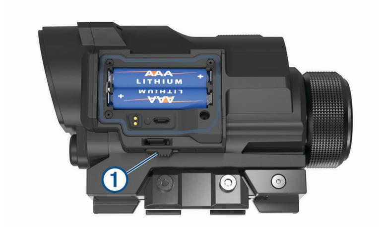
Die Batterieabdeckung am Visier wird entriegelt.
