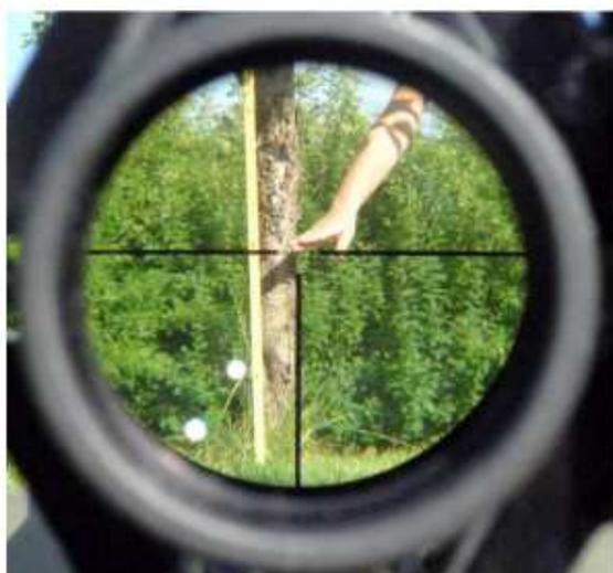
Sur la photo ci-dessus vous pouvez voir l'installation. L'arme a été positionnée à 5m d'un arbre. Un collaborateur met sa main à l'intersection du réticule et lit la hauteur sur le mètre ruban. Il s'avère que la hauteur mesurée est de 50cm.
