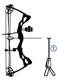
Il dispositivo rileva i colpi e visualizza automaticamente le misurazioni durante il colpo. La velocità misurata è la velocità della freccia mentre passa sopra il cronografo.
